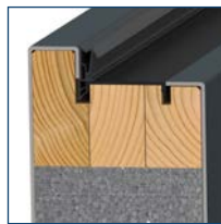
Wypełnienie izolacyjne ekspandowany polistyren modyfikowany grafitem
